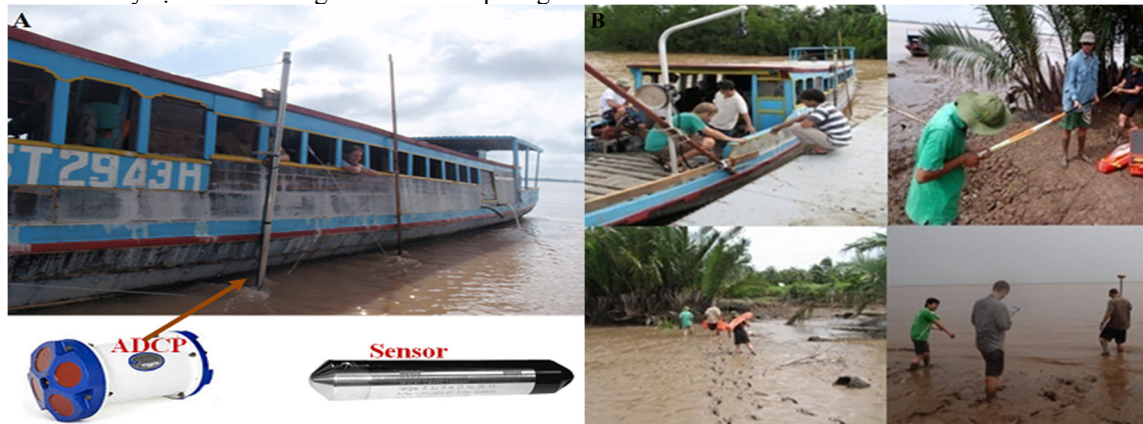
Hình 2: Tàu khảo sát và các thiết bị đo đạc (A); xác định vị trí xói lở ở gần cửa sông (B)
